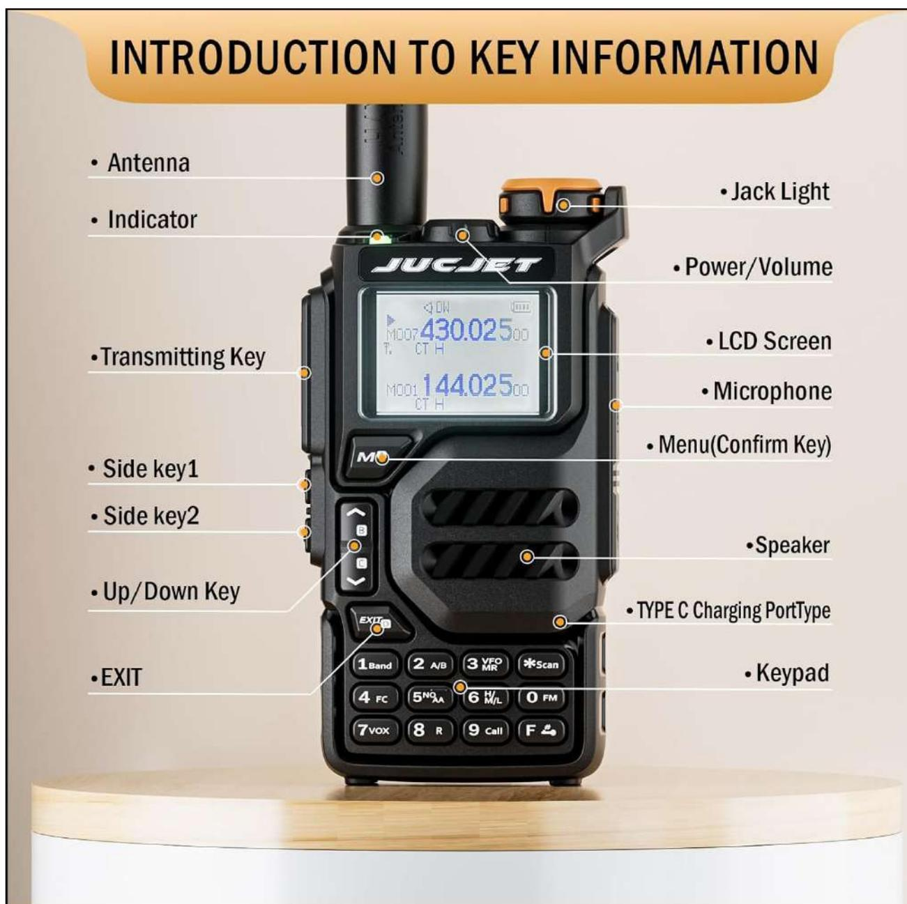
Après avoir injecté et testé une multitude de firmwares, seuls 2 ont retenu toute notre attention. De ce fait, notre appareil possède un analyseur de spectre très détaillé avec de nombreux réglages et ce dès 18 MHz à 1300 MHz...
